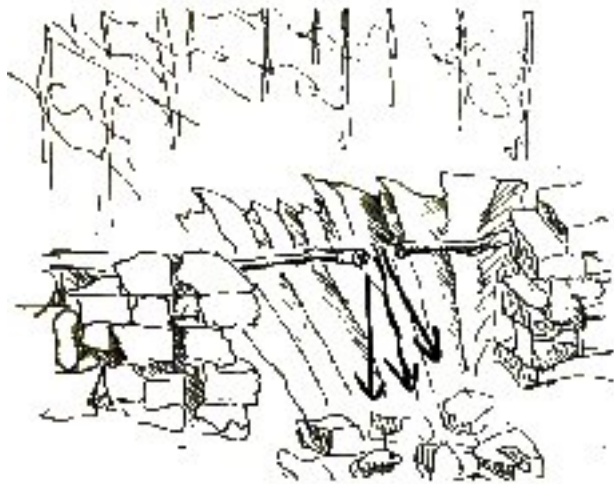
Schema 7: Rotture di tubi di conduzione dell'acqua
