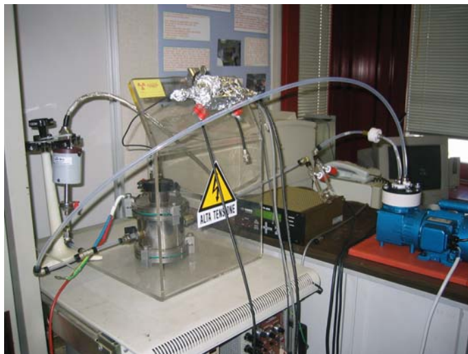
La versione da laboratorio del sistema di monitoraggio RaMonA, viene utilizzato per misurare il radon nel suolo.
